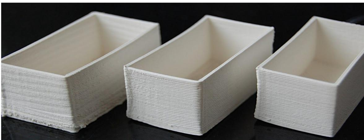
Soft/Medium Drucktests - Überschaubung am linken Druck. Mitteldruck, Schichthöhe rechter0.4, Druck mm0.35
