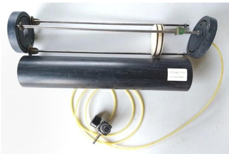
Eine Verbesserung, die ich bei der Konstruktion des schwarzen Behälters vorschlagen würde, ist die Verwendung von vier langen Stangen anstelle von drei Stangen, die die beiden Endkappen in Längsrichtung zusammenhalten. Der Behälter steht unter einem Druck von 4 -
