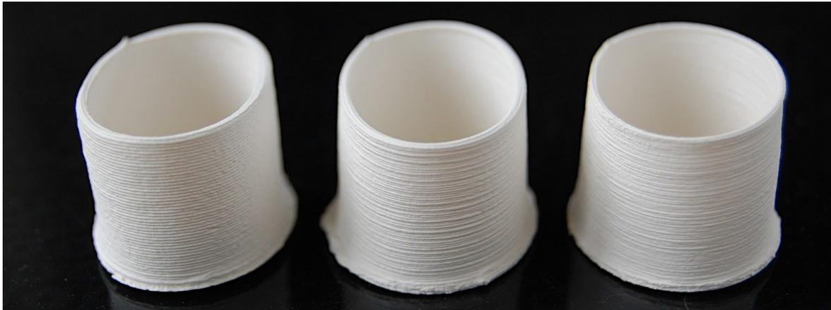
Weiche/Mittlere Mischung - Schichthöhenprüfung: links mm0.4, Mitte 0,3mm, rechts mm0.2
