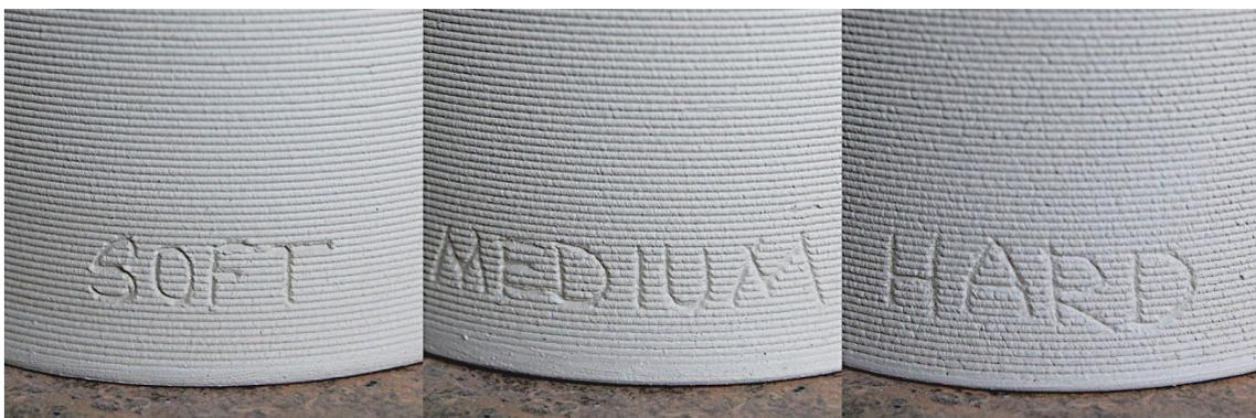
Leichte Variation der Oberflächentextur: Je weicher die Extrusion, desto glatter das Ergebnis.
