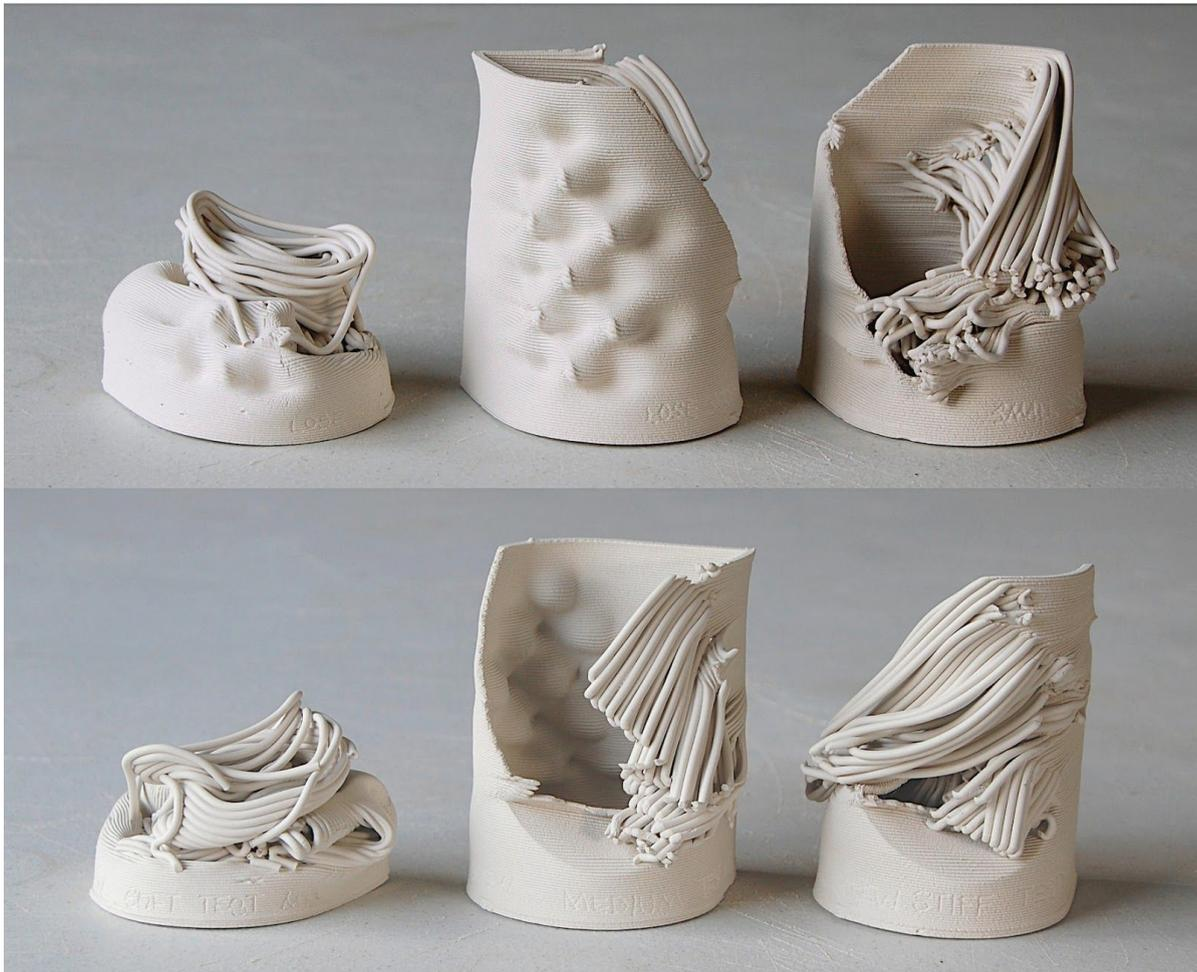
Zwei Ansichten der Drucktests mit weichem, mittlerem und hartem Ton. Von links nach rechts - weicher, mittlerer und harter Ton. Das obere Bild zeigt die Seite mit der wiederholten Reliefstruktur des Tests und das untere Bild die Seite mit den 45°-Winkel-Eindrücken.
